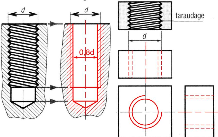
7.2- Compléter le dessin de l'assemblage entre la pièce 1 et 2 par la vis 3 ?
