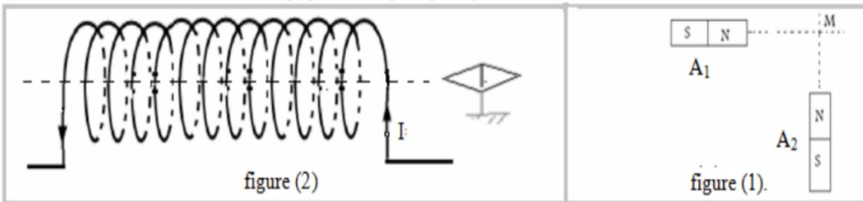
2) On considère une bobine de rayon  $R=2,5\text{cm}$  et de longueur  $L=60\text{cm}$  composée de  $N=600$  spires et parcourue par un courant électrique d'intensité  $I=239\text{mA}$  comme l'indique la figure (2).
