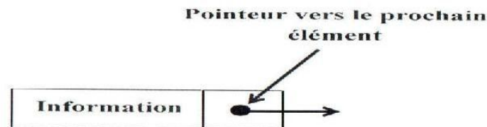
Représentation d'une cellule avec un seul pointeur.
