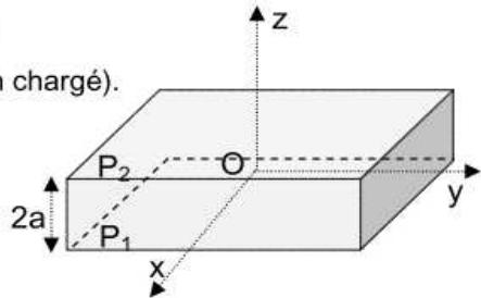
2) Pour  $z \geq 0$  : Th. de Gauss :  $\Phi_{(\vec{E}/SG)} = \iint_{SG} \vec{E} \cdot d\vec{s} = \frac{\sum q_{\text{int}}}{\epsilon_0}$
