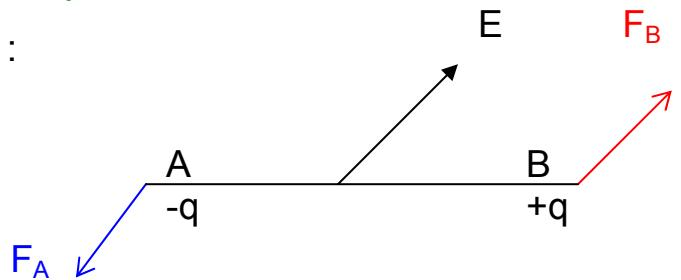
$$\vec{\Gamma} = O\vec{A} \wedge \vec{F}_A + O\vec{B} \wedge \vec{F}_B = O\vec{A} \wedge -q\vec{E} + O\vec{B} \wedge q\vec{E} = (O\vec{B} - O\vec{A}) \wedge q\vec{E} = \vec{AB} \wedge q\vec{E} = q\vec{AB} \wedge \vec{E}$$
